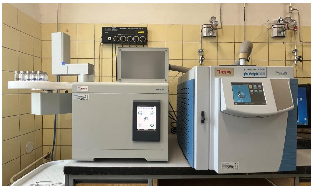
Obrázek 4 - Headspace autosampler Thermo Tri Plus 300 a plynový chromatograf Thermo Trace 1310 Series
