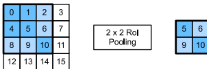
Obrázek 3.4: Ilustrace znázorňující fungování ROI pooling vrstvy. Převzato z [27].
