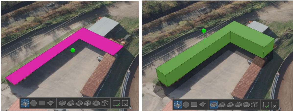
Obrázek 18 - Zelený bod, sloužící pro vytažení plochy do prostoru a funkce flat roof
