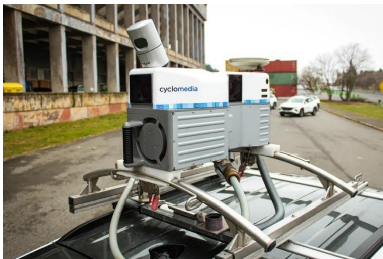
Obrázek 12 - CycloMedia mobilní systém upevněný na automobilu (Garáž.cz, 2022)
