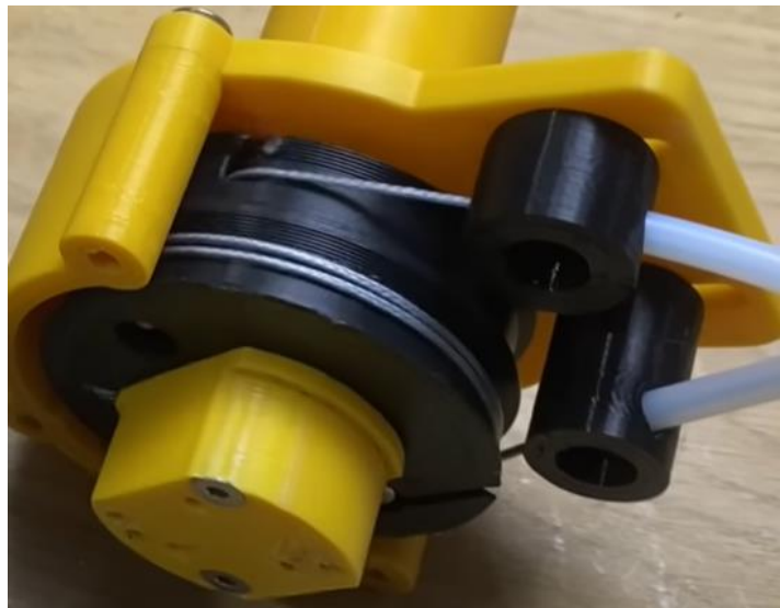
Obrázek 21 Uložení lan Bowdenova převodu [27]
