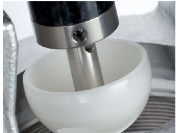
Obr. 11: Snímací senzor s keramickou polokoulí [6]
