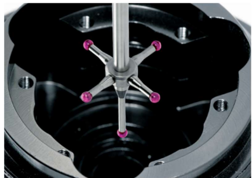
Obr. 8: Hvězdicový snímací senzor [6]
