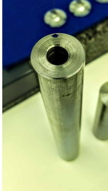
Obr. 35: Referenční součást s otvorem Ø 10,5 mm
