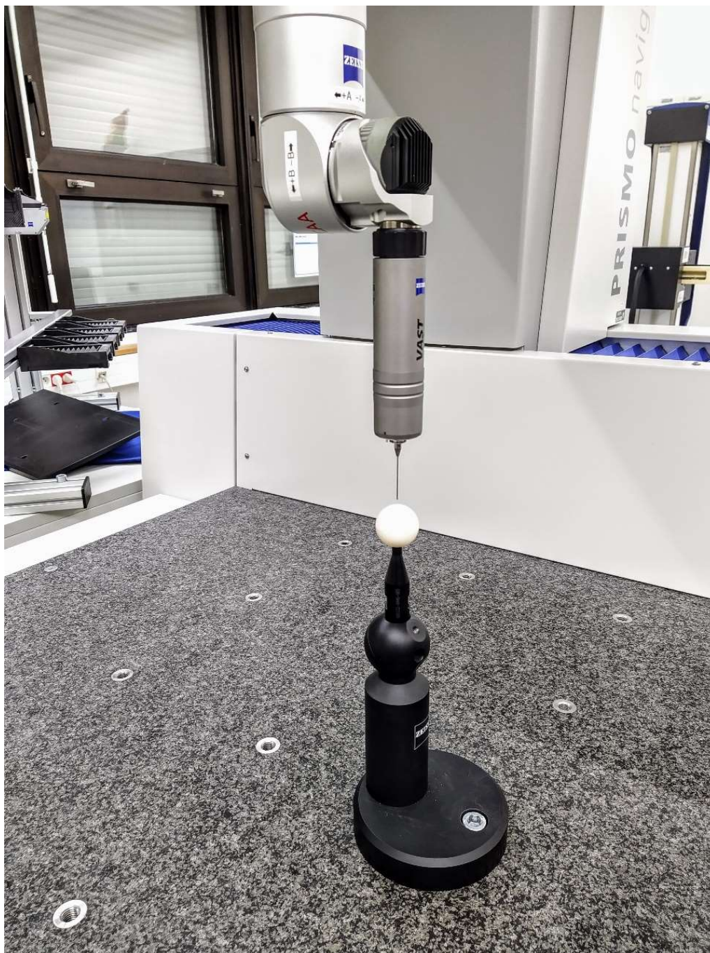
Obr. 37: Kalibrace jednoho ze snímacích senzorů pomocí keramické kalibrační koule
