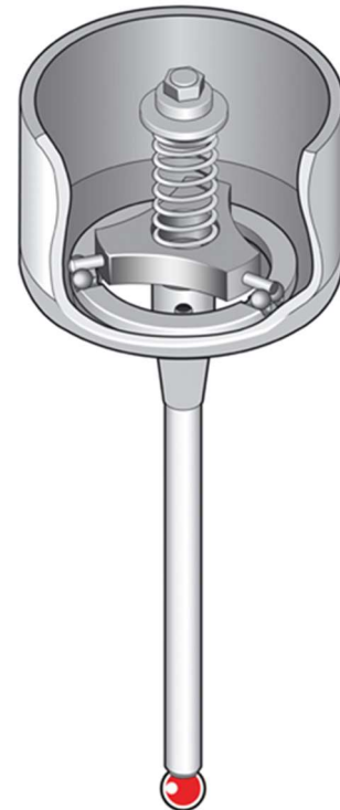
Obr. 27: Standardní trojúhelníkové uspořádání kinematicky odporové sondy [10]
