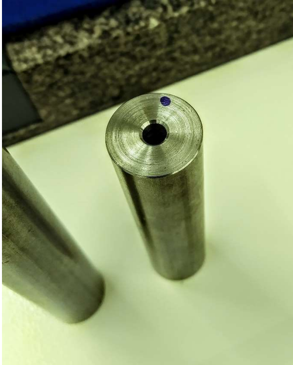
Obr. 34: Referenční součást s otvorem Ø 6,5 mm
