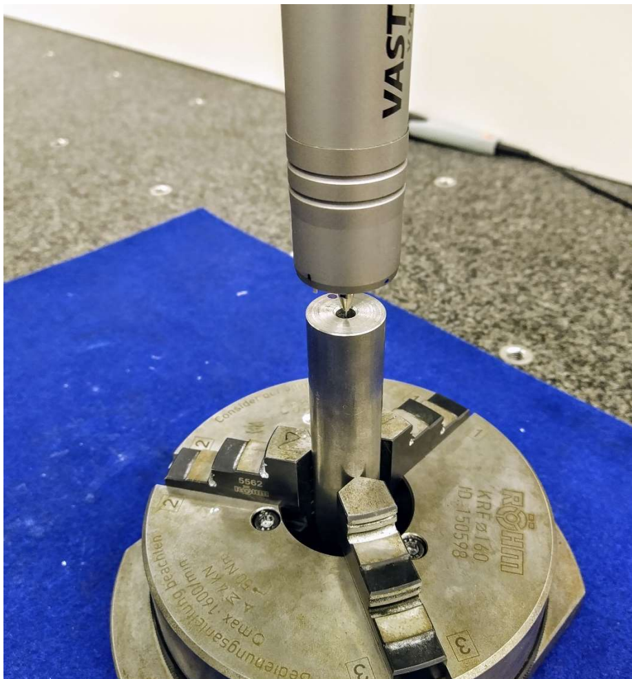
Obr. 44: Ukázka měření v maximální programované hloubce vrtaného otvoru \varnothing 6,5 \text{ mm}
