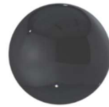
Obr 16: Kulička s diamantovým povlakem [7]
