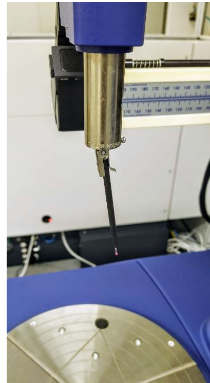
Obr. 33: Detail snímacího senzoru kruhoměru
