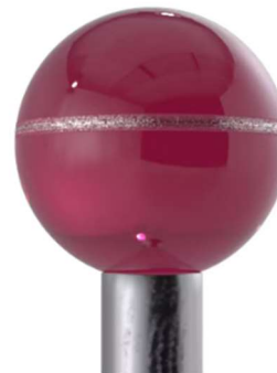
Obr. 25: Nárůstek materiálu na kuličce [7]
