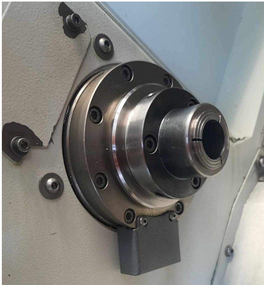
Obrázek 27 Vřeteno s otvorem upínacího rozhraní
