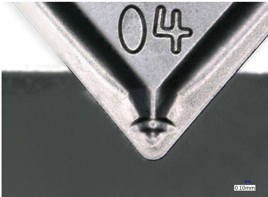
Obrázek 19 VBD po orientační zkoušce obrábitelnosti 1
