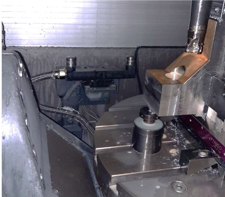
Obrázek 7 Renishaw laserový presetter na stroji KOVOSVIT MAS MCU 450VT-5X
