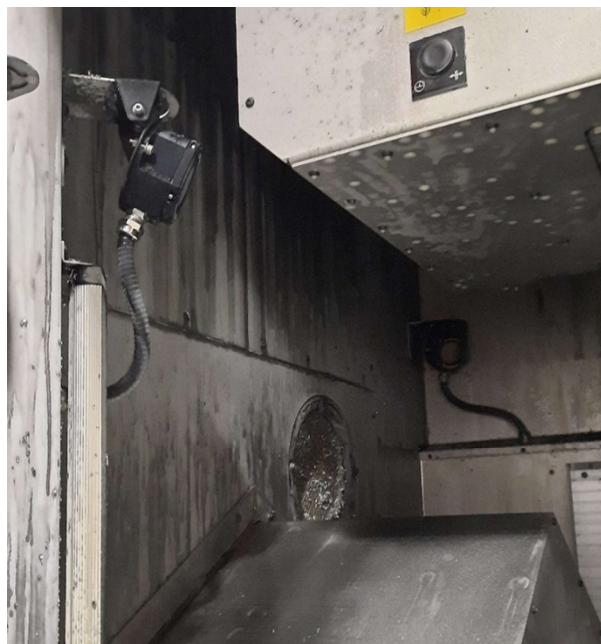
Obrázek 8 Senzory pro měření rozměrů na stroji KOVOSVIT MAS MCU 450VT-5X
