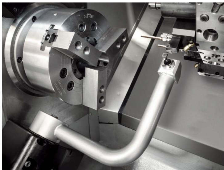
Obrázek 11 Sondovací hrot výrobce Haas [20]
