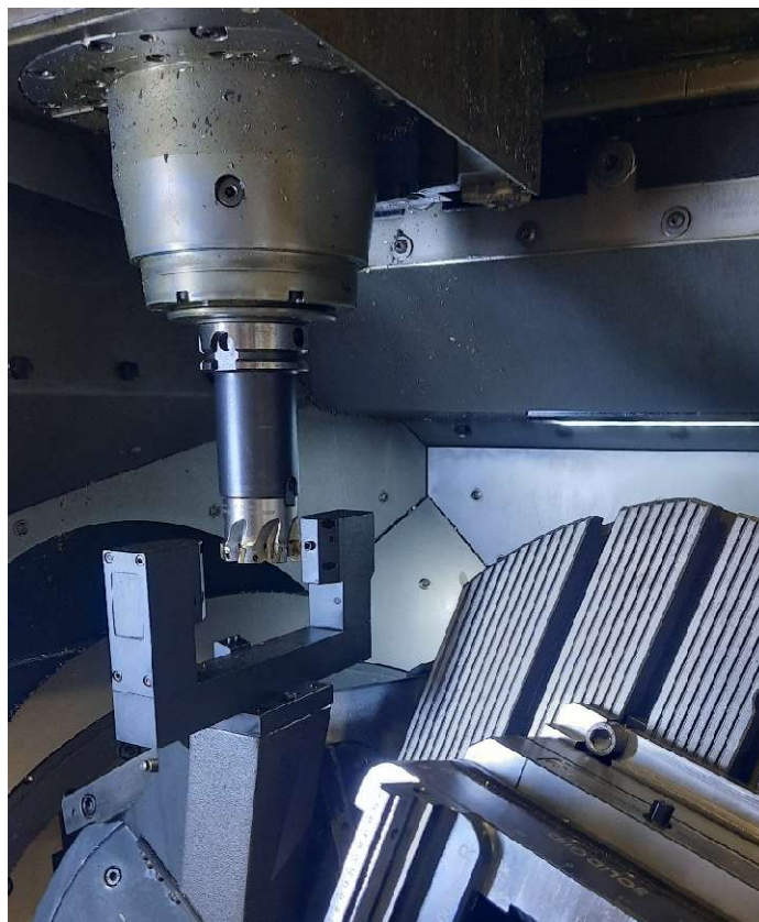
Obrázek 13 Laserové zaměření na DMG MORI DMU 40 eVo linear
