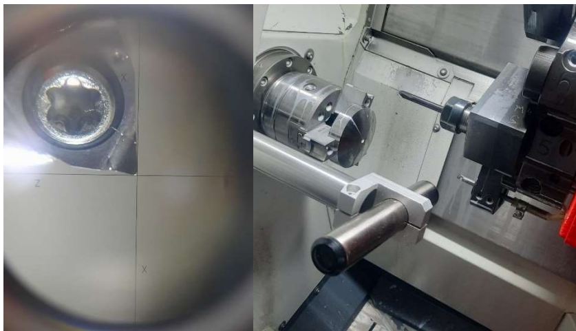
Obrázek 17 Optický zaměřovací přípravek EMCO s detailem zaměření
