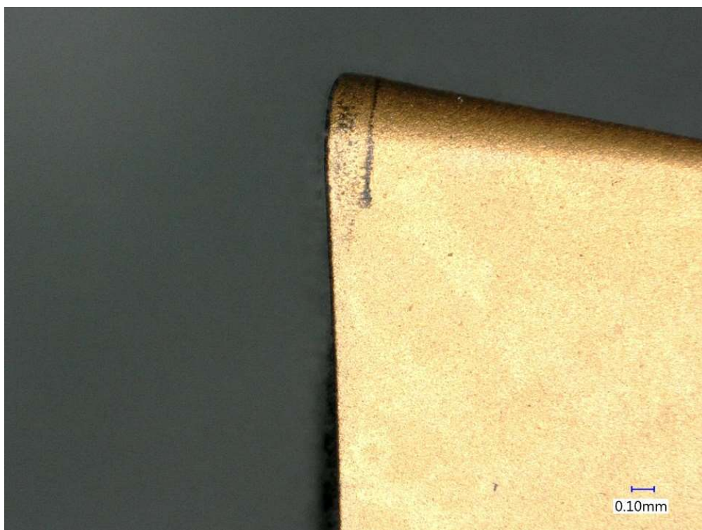
Obrázek 20 VBD po orientační zkoušce obrábitelnosti 2
