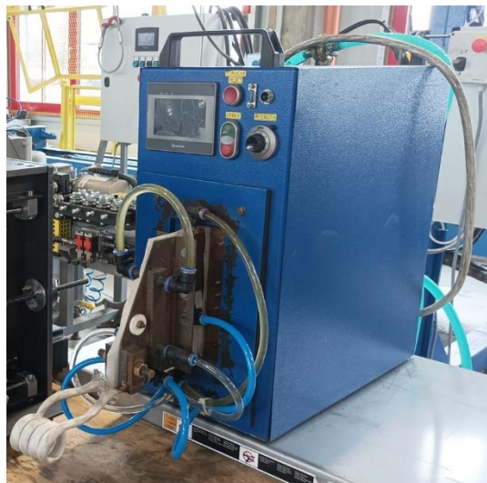
Obrázek 2 - Středofrekvenční zdroj na pracovišti indukčního ohřevu
