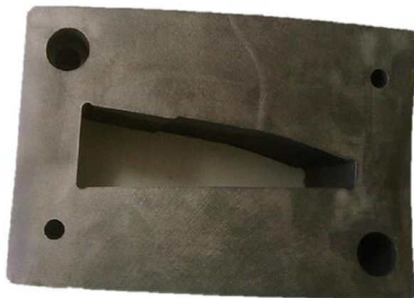
Obrázek 21 Lisovací vložka po tisku [24]
