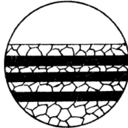
Obrázek 5 Koroze po vrstvách [3]
