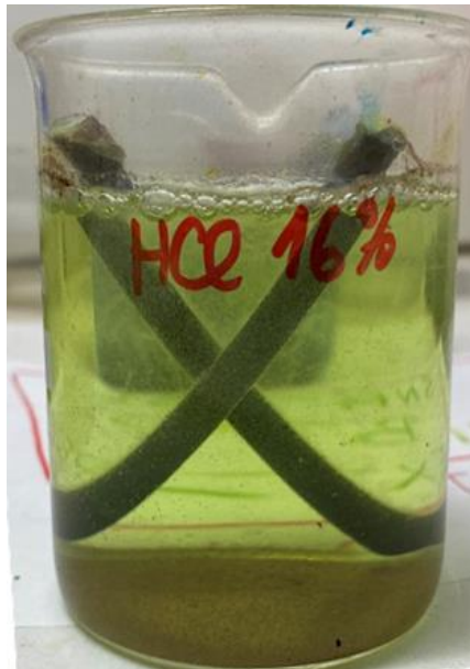
Obr. 27- HCl o koncentraci 16 % se vzorky drátů
