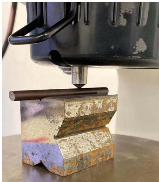
Obr. 30-Způsob měření povrchové tvrdosti
