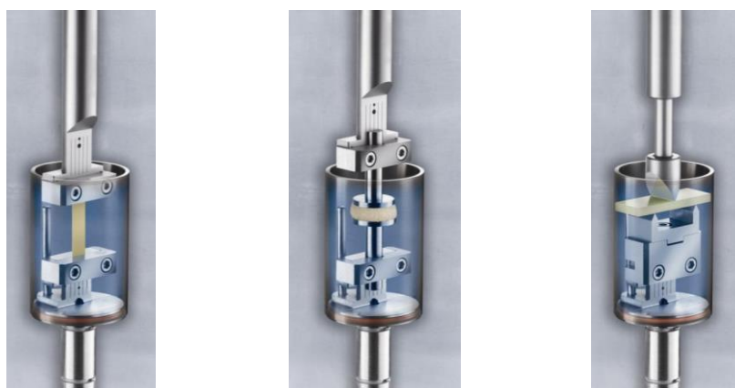
Obr. 13: Typy držáků pro různé namáhání. Zleva – tahový držák, kompresní držák, tříbodový ohyb. (převzato z [30]).
