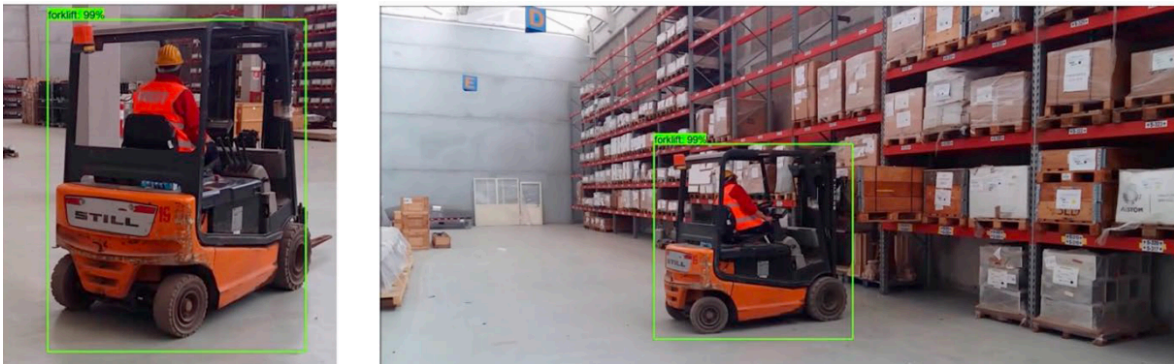
Obr. 13 Názorné představení sledování pohybu pomocí VISR (Převzato z [36])
