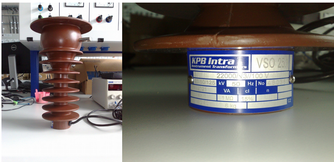
Obr. 27 Kapacitní dělič VSO25.1, výrobní štítek
