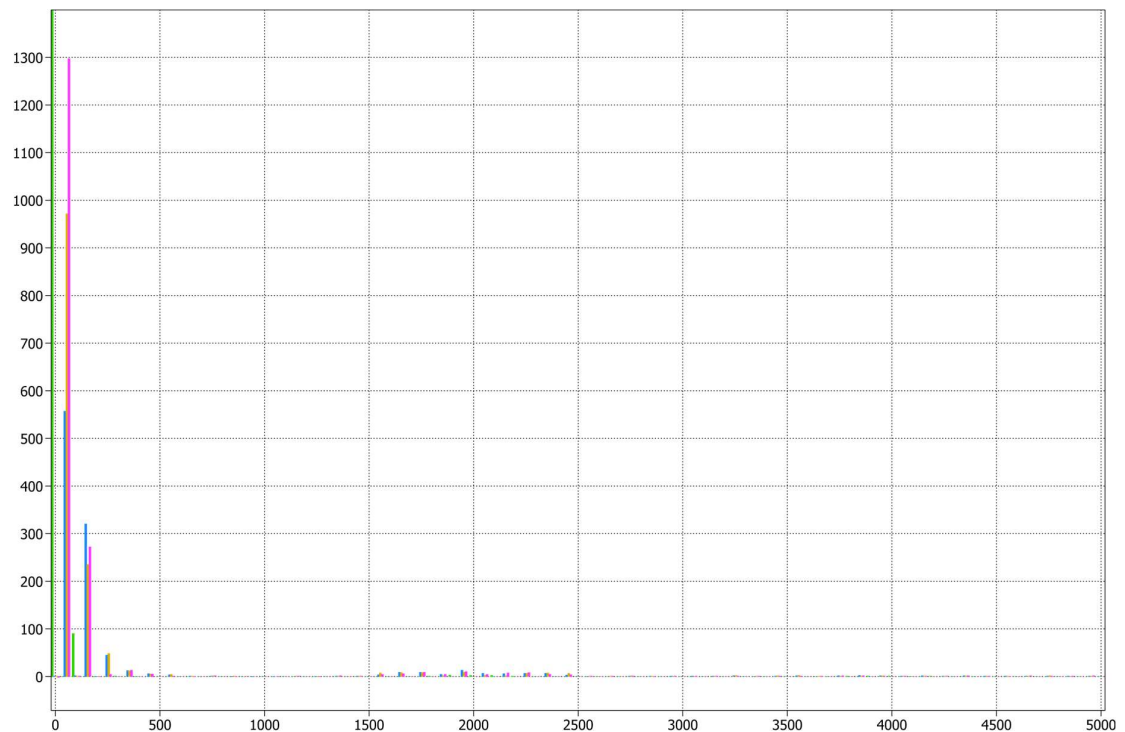
Obrázek 38 Harmonické spektrum vstupních fázových proudů a napětí ve stejnosměrném meziobvodu (zeleně)
