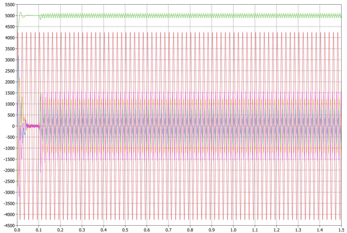
Obrázek 39 Průběhy sdruženého napětí L12 (červeně), napětí ve stejnosměrném meziobvodu (zeleně) a všech tří vstupních fázových proudů (fialově, žlutě, modře)
