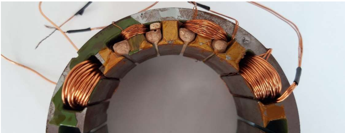
Obr. 67: Navinuté cívky. Vlevo cívka z vodiče o průměru 1,25 mm. Vpravo cívka z vodiče o průměru 0,71 mm. Druhá cívka zleva z vodiče o průměru 0,35 mm s n_p = 1 . Druhá cívka zprava z vodiče o průměru 0,35 mm s n_p = 3 .
