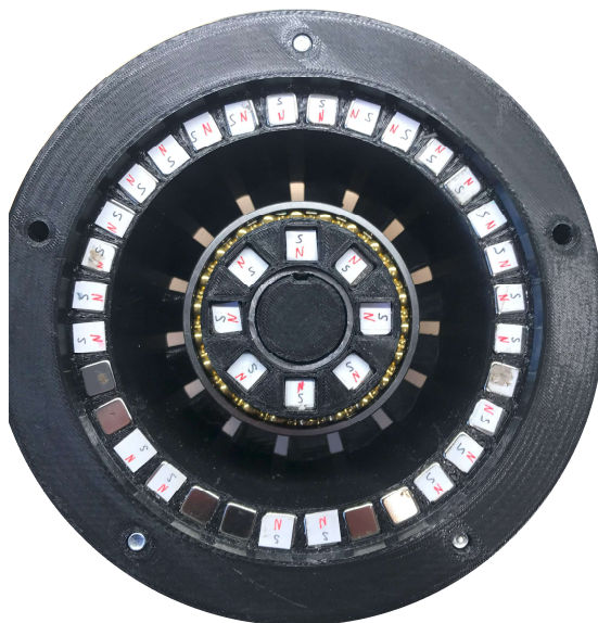
Obr. 5.11 Hlavní rotorová část osazená permanentními magnety s označenou polarizací (North, South)
