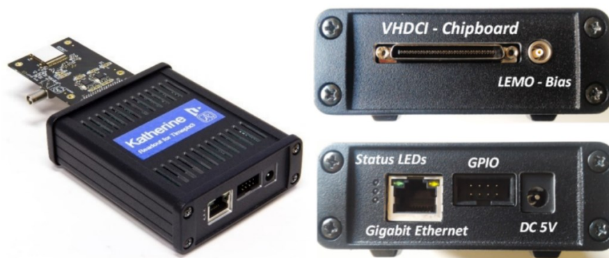
Obr. 4: Vyčítací zařízení Katherine Gen1 s připojeným Timepix3 detektorem nalevo
