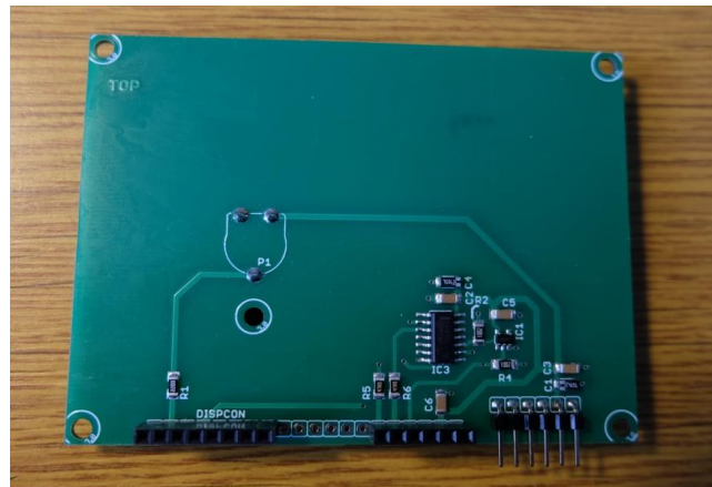
Obr. 3.6 Přídavný modul displeje s budiči sběrnice
