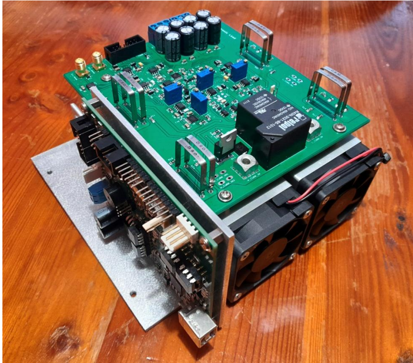
Obr. 3.2 Kompletní modul zátěže s řídicí jednotkou
