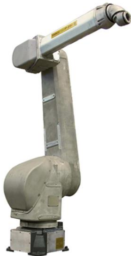
Obrázek 7 – Lakovací 6-osý angulární robot Fanuc P-250iB/15 s dutým zápěstím [11]
