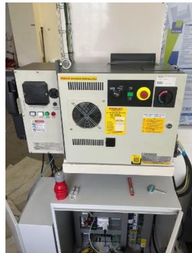
Obrázek 85 - Pohled na rozvaděč robotu s přidavným vzdušníkem pro systém natlakování robotického ramene
