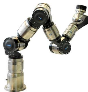
Obrázek 3 - Redundantní 9-osý robot Schunk LWA se sériovou kinematickou strukturou [5]
