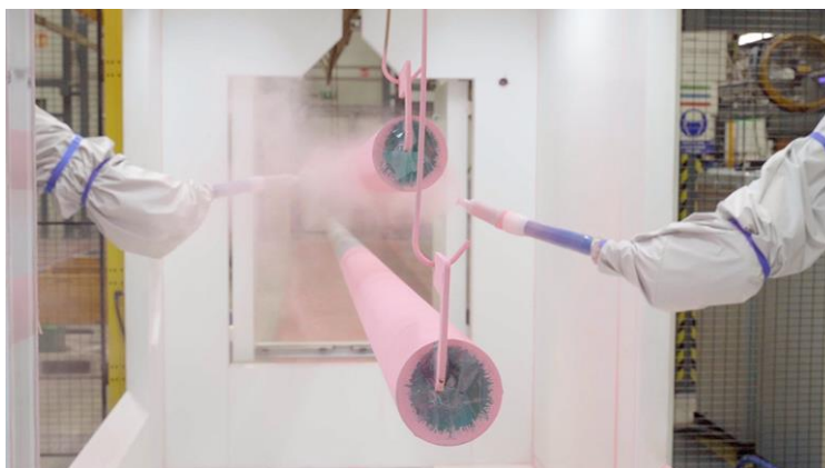
Obrázek 22 - Automatická robotická kabina se 2 roboty [42]
