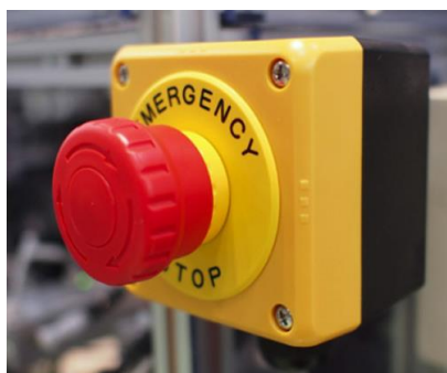
Obrázek 20 - Ovládání nouzového zastavení s červeným hřibovitým tlačítkem na žlutém panelu [33]
