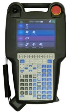
Obrázek 86 - Ruční kontrolér Fanuc iPendant [73]
