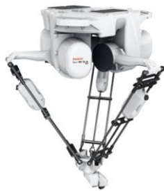
Obrázek 2 - 6-osý Delta robot Fanuc M-3iA/6A s paralelní kinematickou strukturou [4]
