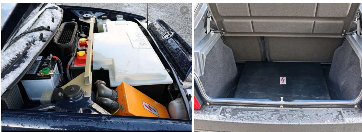
Obrázek 1: Škoda Eltra 151 L – motorový a zavazadlový prostor [6]
