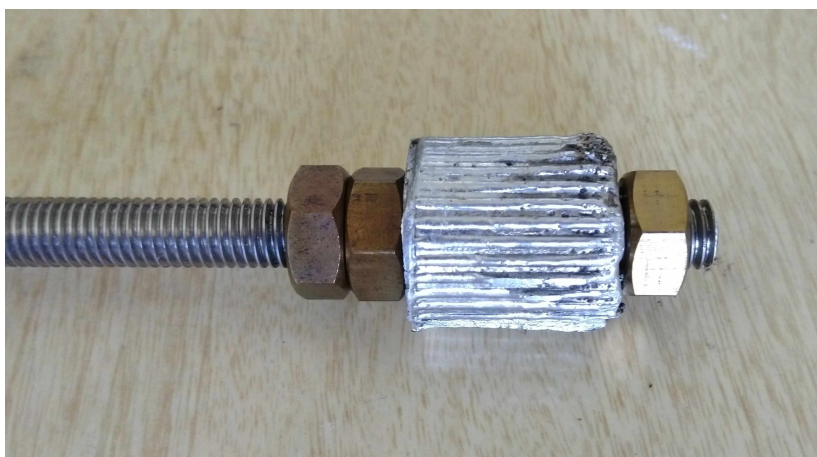
Obr. 2.3 Přípravek pro opevnění hřídele v rotačním manipulátoru.
