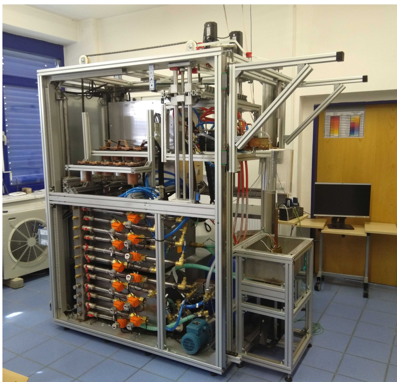
Obr. 1.2 Kalící zařízení s frekvenčním měničem FRQ 60.
