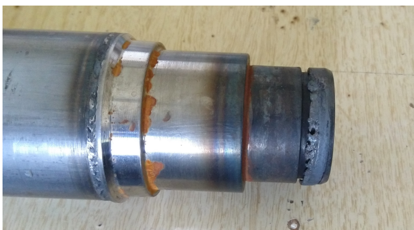
Obr. 2.4 Hřídel poškozený během kalení dvouzávitovým válcovým induktorem.
