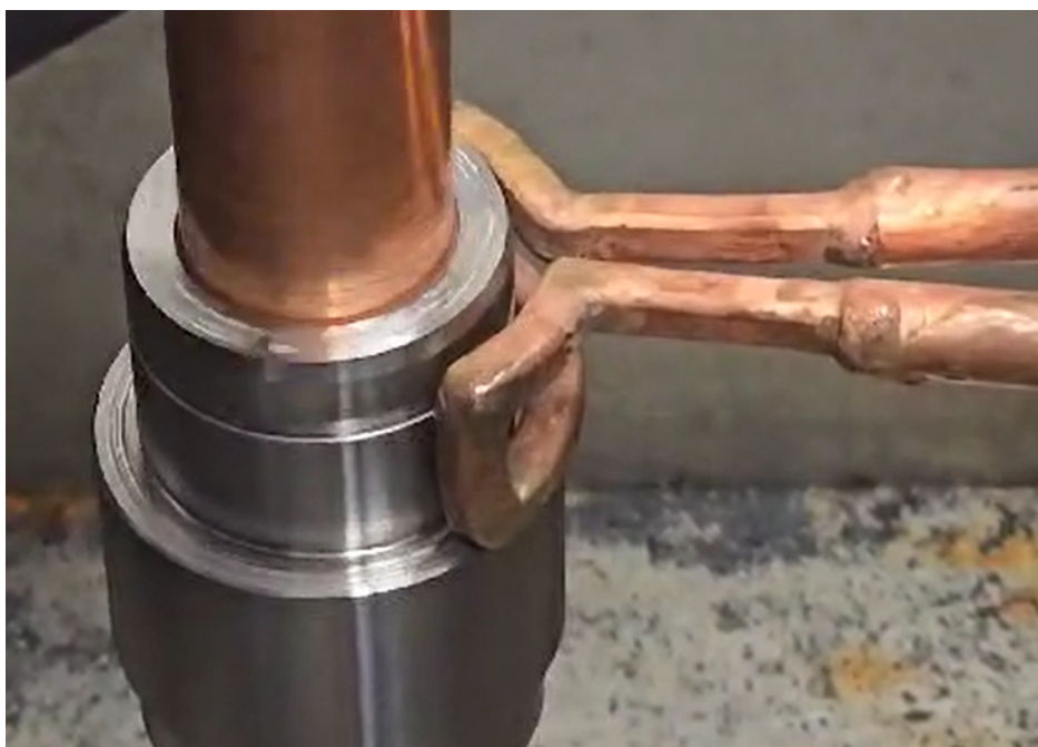
Obr. 2.6 Induktor umožňující prohřát dno drážky.
