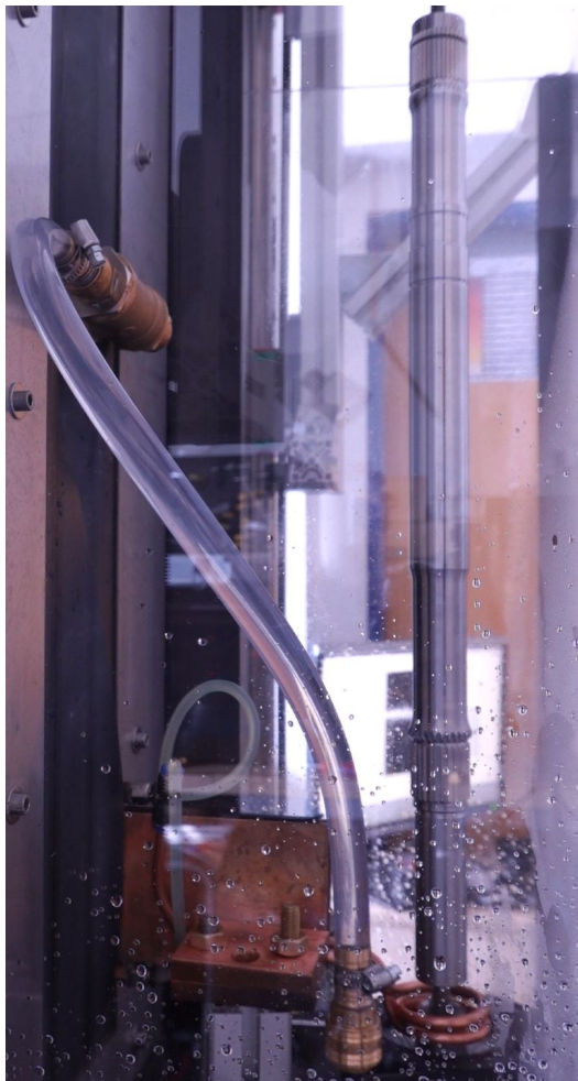
Obr. 1.5 Kontinuální kalení hřídele.
