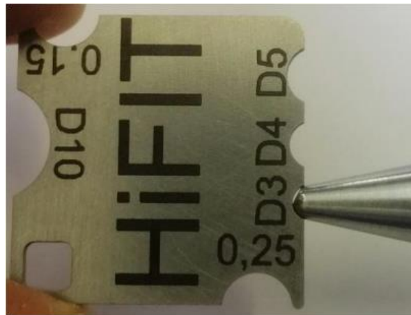
Obrázek 43: Kontrola hrotu pomocí měřidla [21]
