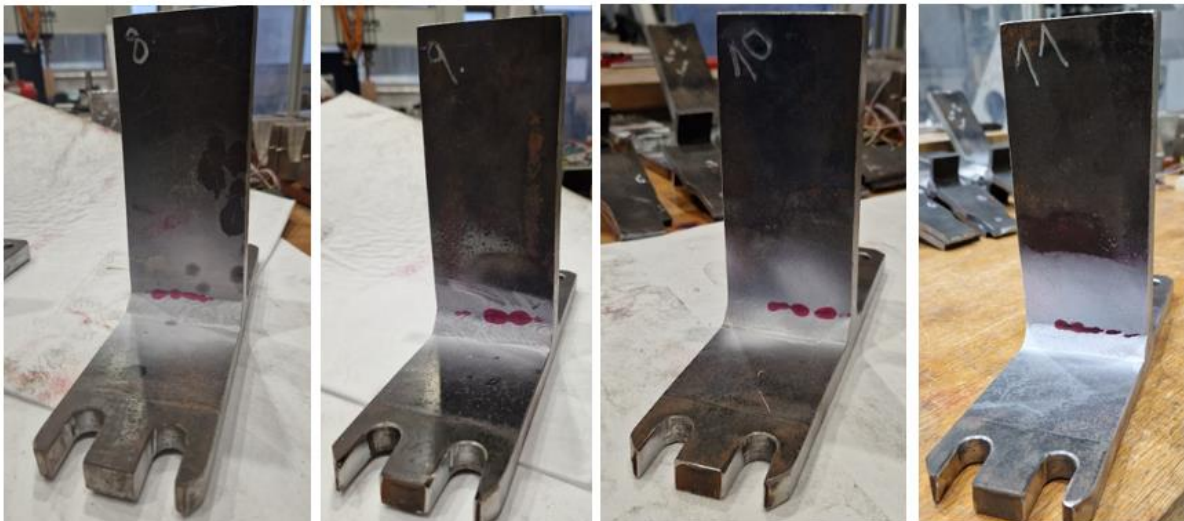
Obrázek 38: Detekce trhliny pomocí kapilární zkoušky
