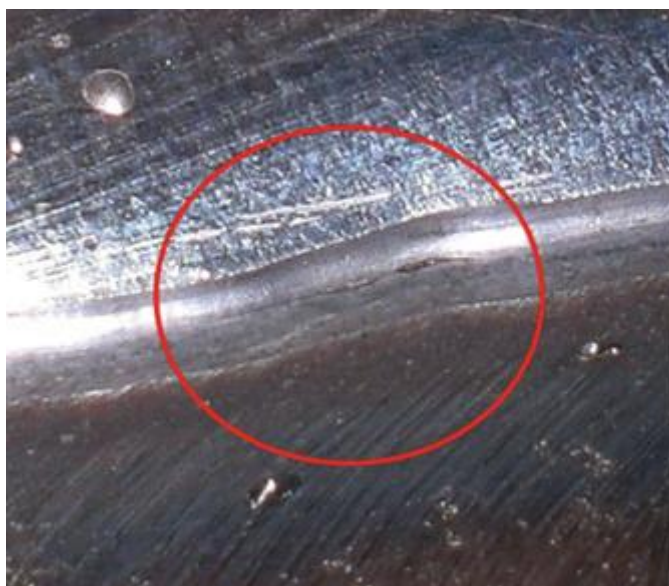
Obrázek 14: Nedostatečně opracovaný svarový spoj [5]
