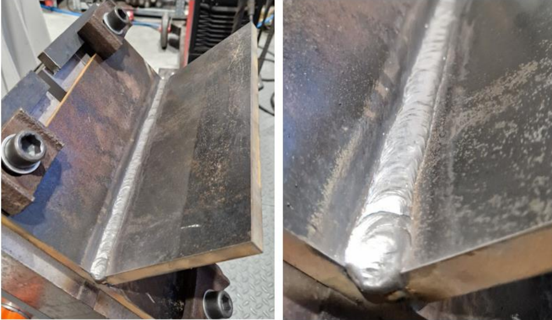
Obrázek 34: Celkový svařenec a detail svarové housenky
