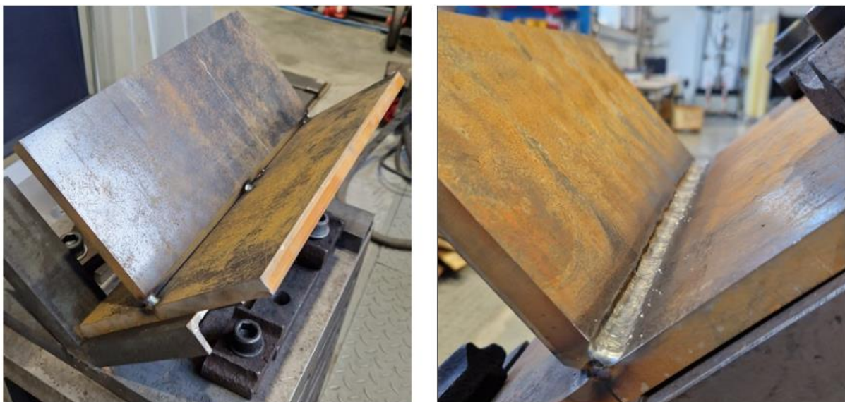
Obrázek 33: Svařovací přípravek, heftování a první souvislý svar
