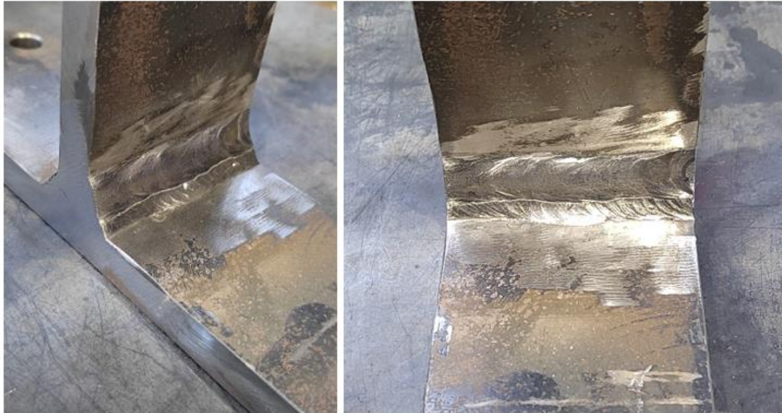
Obrázek 41: Aplikace HFMI na očištěný svar
