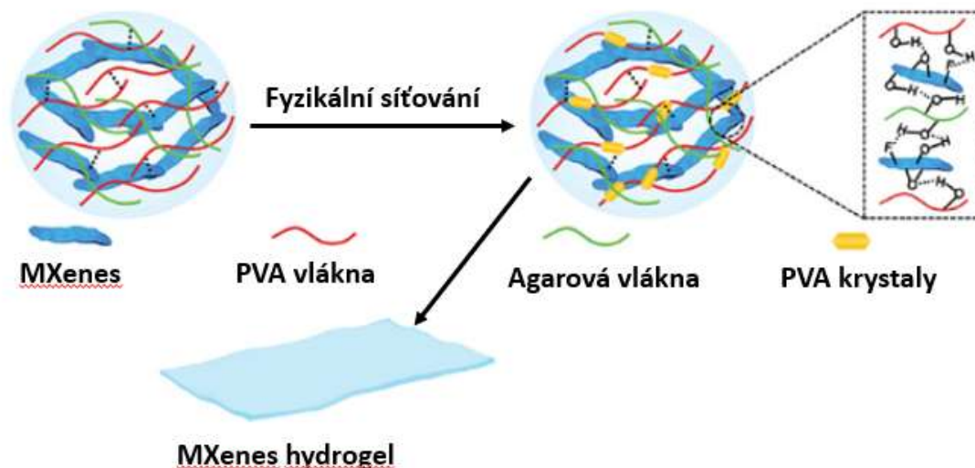
Obrázek 4.4 – Schéma přípravy MXenes hydrogelu [20]
