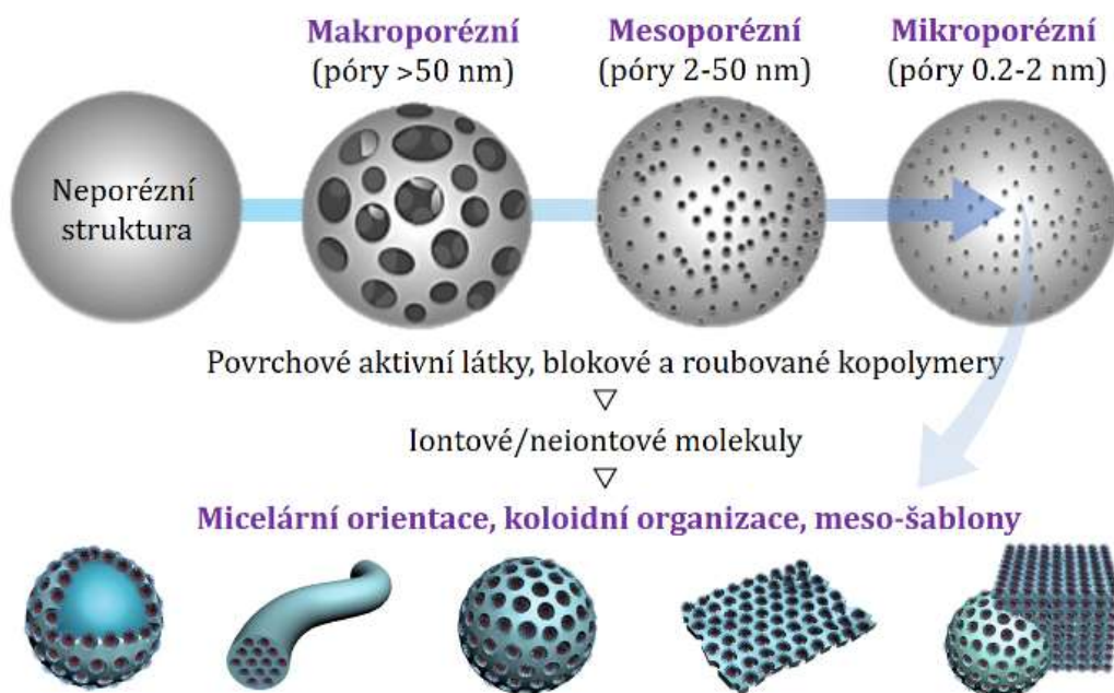
Obrázek 2.3– Schéma úrovně a možné organizace porézních struktur [5] [6]
