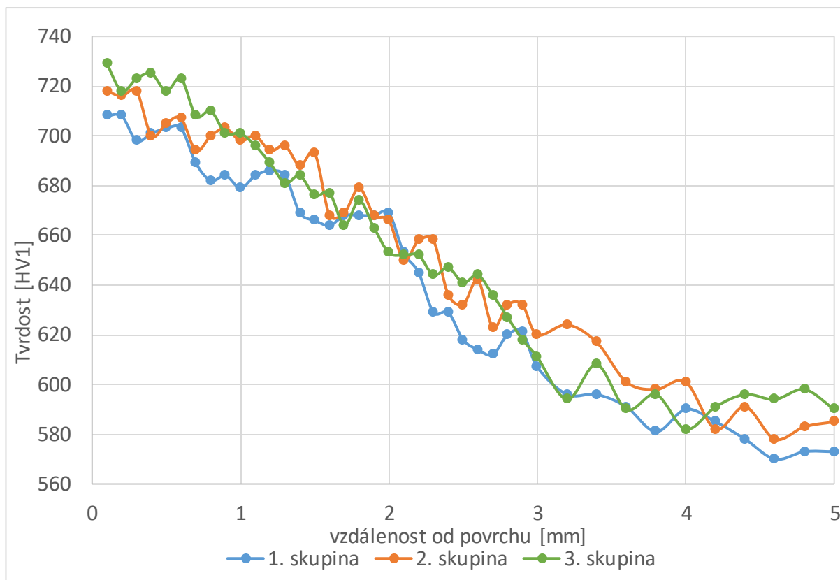
Obr. 45: Gradient tvrdosti po TZ po kalení z 1050 °C + popouštění 150 + 575 °C s ochranou proti oduhličení
