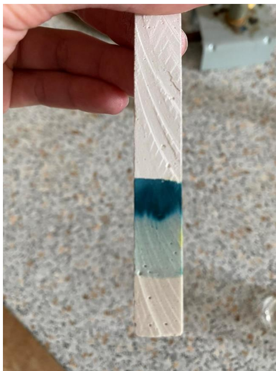
Obrázek 17: Chromatografie černého fixu na křídě (ethanol)
