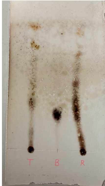
Obrázek 16: TLC troudnatce kopytovitého n-hexan:ethyl-acetát (10:3) (T- troudnatec kopytovitý, B- betulin, R- rezavec šikmý)
