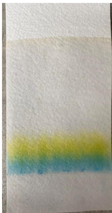
Obrázek 19: Chromatografie zeleného potravinářského barviva (chromatografický papír)
