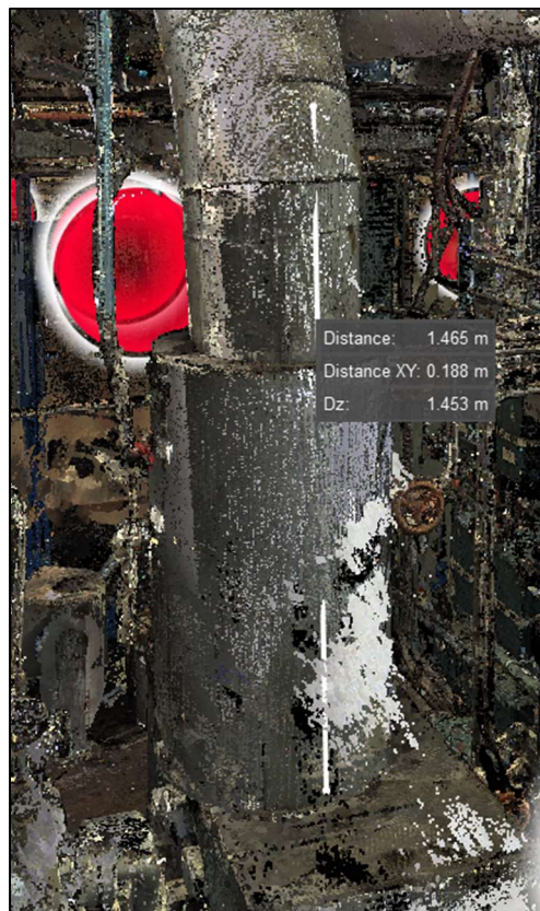
Obr. 23: Měření vzdáleností v programu Truview
