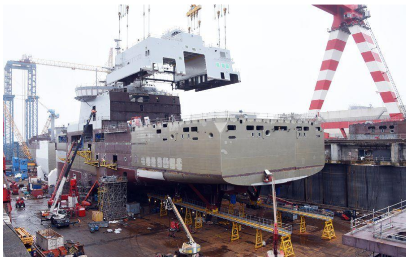
Obrázek 21: Pevné uspořádání - montáž lodi [29]
