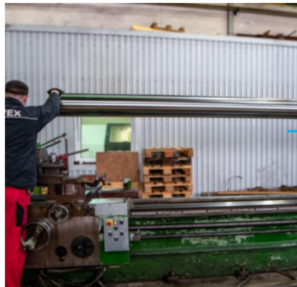
Obrázek 4-7: Strojní broušení chromu [41]
