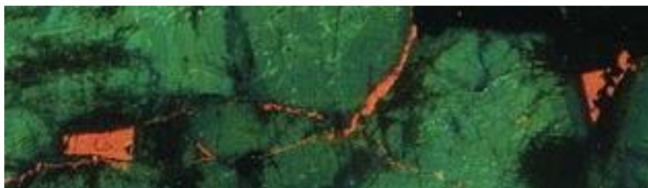
Obrázek 3-9: Ukázka katodové luminiscence (hrubozrnný tmavý granit – durbachit) [38].
