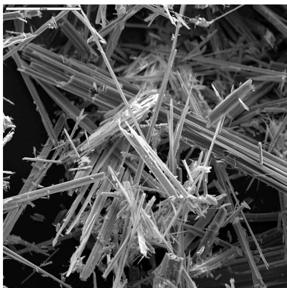
Obrázek 2-8: Morfologie vlákna amfibolového typu azbestu [14], vpravo: struktura vlákna: zeleně – tetraedry \text{SiO}_4 (dvojitý řetězec), žlutě a fialově: kationty Na, Ca, Mg, \text{Fe}^{2+} nebo \text{Fe}^{3+} [107].
