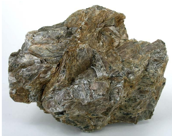
Obrázek 2-10: Jeden z produktů výsledku tepelného rozkladu amfibolů (pyroxen – enstatit) [20].
