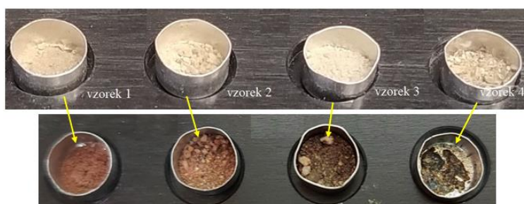
Obrázek 4-23: Vzorky 1. série s označením 1 - 4 před a po ohřevu na 1200°C v analyzátoru SDT 650
