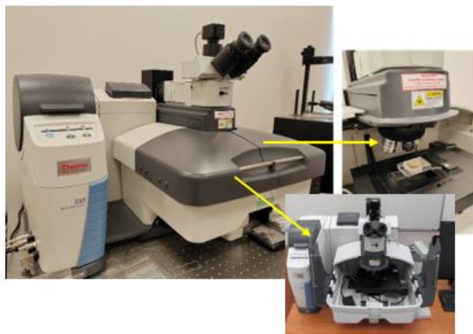
Obrázek 4-48: Ramanův DXR mikroskop s excitačním laserem
