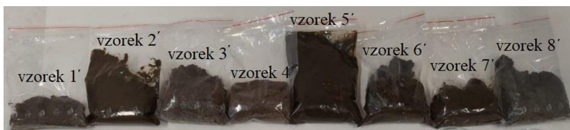
Obrázek 4-27: Vzorky 1' až 8' v neprodyšných sáčcích nachystané pro následnou přípravu před provedeními měřeními.
