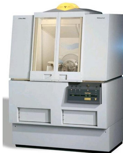
Obrázek 4-6: Práškový difraktometr Panalytical X'Pert Pro pro analýzu rentgenové difrakce
