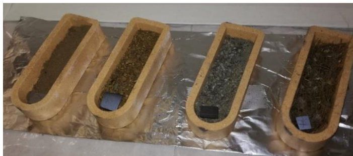
Obrázek 4-8: Vzorky 1. série před žíháním v horizontální vakuové trubkové peci.
