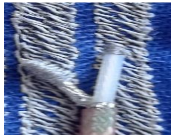
Obr. 28 - přišitý koaxiální kabel
