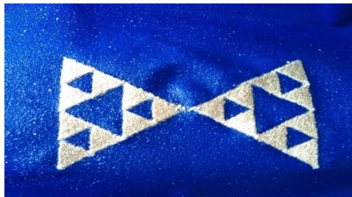
Obr. 90 - testování elektrických parametrů bow-tie antény na účinky lidského potu
