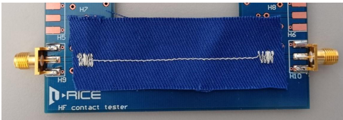
Obr. 54 - vytvořený spoj pomocí přišívání
