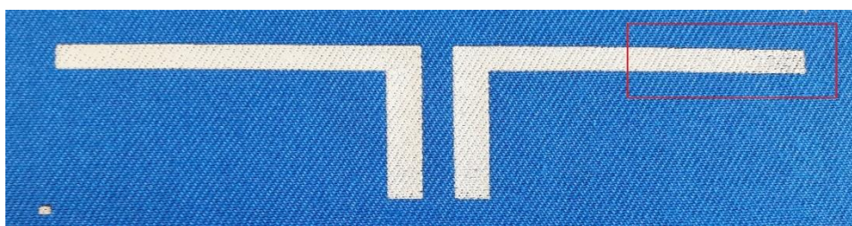
Obr. 76 - dipólová anténa vyrobená pomocí sítotisku
