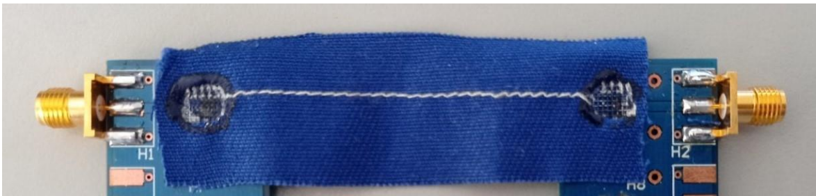
Obr. 62 - spoj vytvořený ultrazvukovým svařováním
