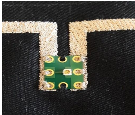
Obr. 29 - plošný spoj s UFL konektorem přišitý k anténě
