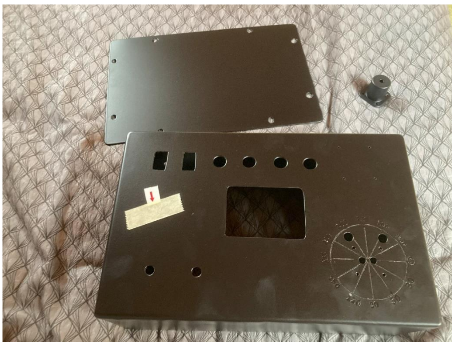
Obr. 19: Nalakované díly připravené na sestavení
