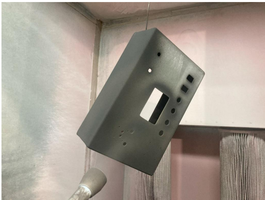
Obr. 18: Průběh lakování dílů
