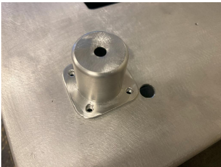
Obr. 17: Kryt motoru připravený na lakování
