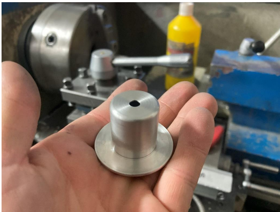
Obr. 16: Polotovar krytu motoru
