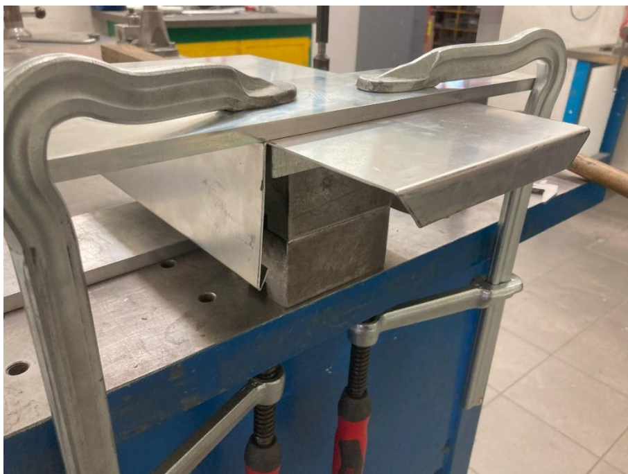
Obr. 13: Tvarování plechového boxu na rýsovací desce
