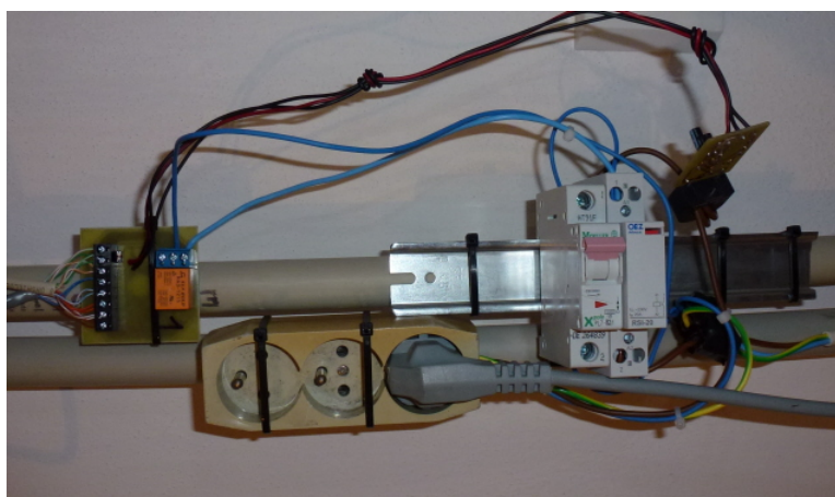
Obrázek 5.5: Zapojení modulu DS2413 s novou zásuvkou u pračky
