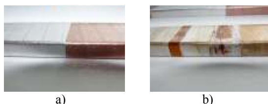
Obr. 5: Vzorky stárnuté pulzním napětím, ±3 kV, 3 kHz, 180 °C, a) původní stav, b) po expozici
