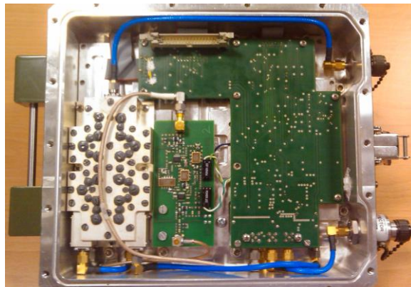
Obr. 6: Fotografie realizace ODU se separátní deskou pro přepínání šířky pásma
