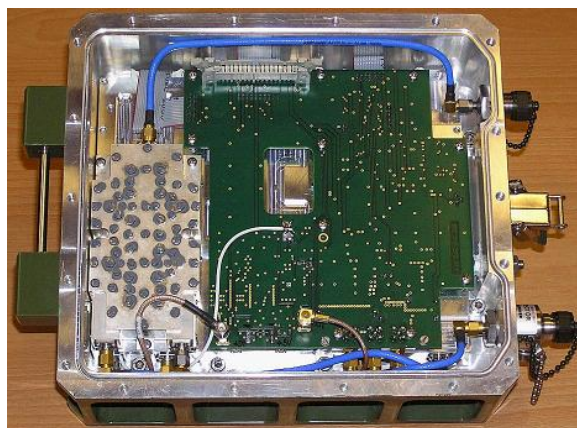
Obr. 7: Fotografie výsledné realizace ODU s integrovanou možností přepínání šířky pásma
