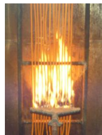
Obr. 1.: Průběh zkoušky šíření plamene kabelů ve svazku [8]
