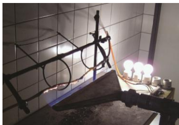
Obr. 2.: Ukázka zkoušky funkční schopnosti kabelů při požáru [8]
