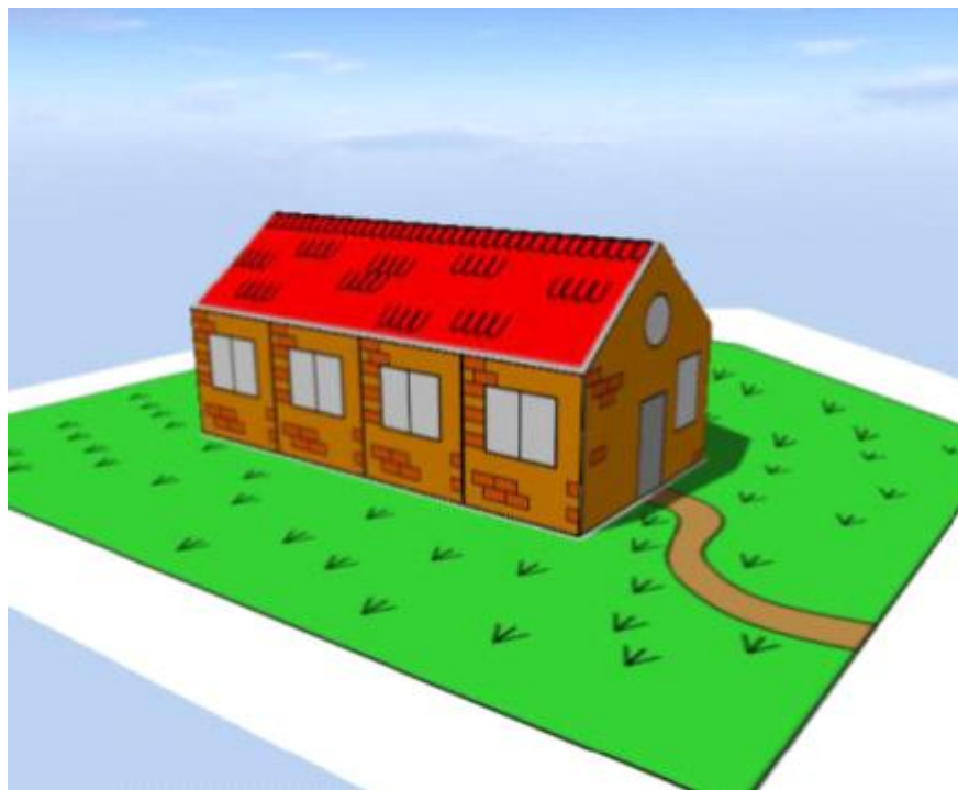
Obr. 5: Možná reprezentace budovy v LOD2 (zdroj: [1])
