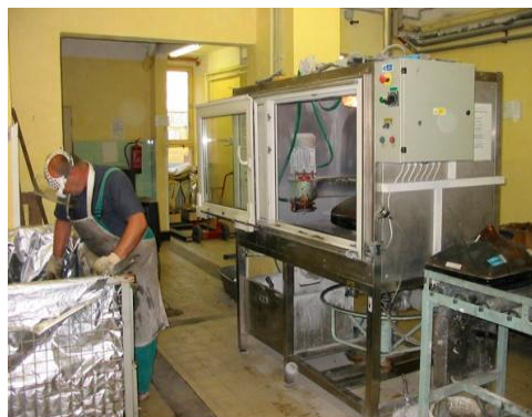
Obr. č. 7: Obsluha magnetického separátoru
