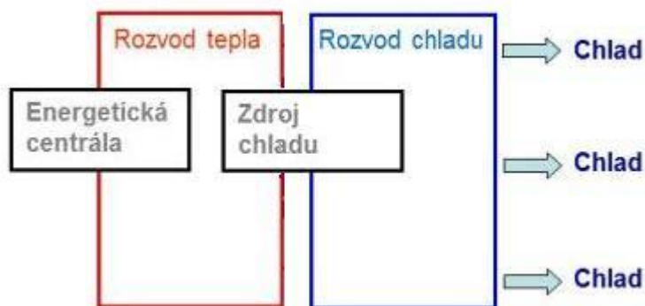
Obr. 3: Schéma dálkového chlazení s centralizovanou produkcí chladu [2]
