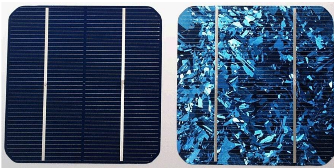
PŘÍLOHA 1 ROZDÍL MEZI MONOKRYSTALICKÝM ČLÁNEM A POLYKRYSTALICKÝM [38]
