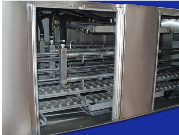
obr. 5-7: Ukázka mycího stroje KLT přepravek firmy NERKON, s.r.o.
