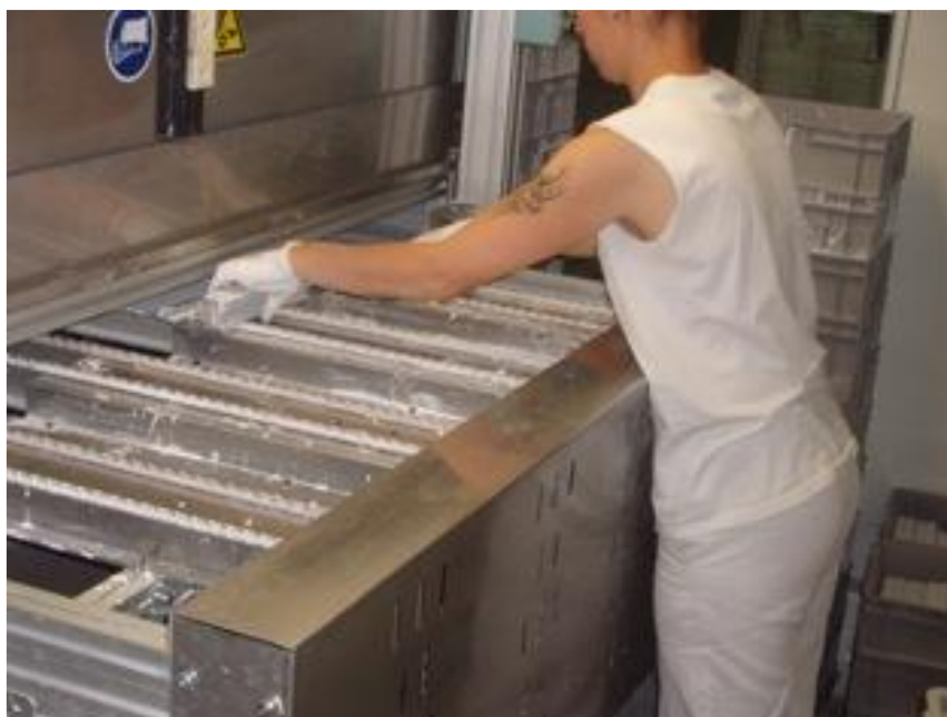
obr. 4-15: Zakládání desek po odmaštění
