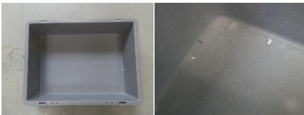
obr. 4-52: Ukázka KLT přepravky pro skladování desek po odmaštění a nanesení fluxu
