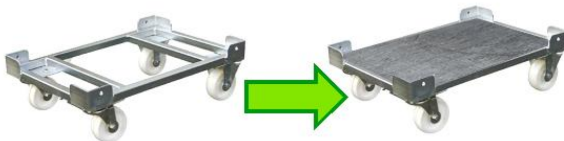
obr. 5-6: Navrhovaná konstrukční změna přepravních vozíků pro stohování inner finů
