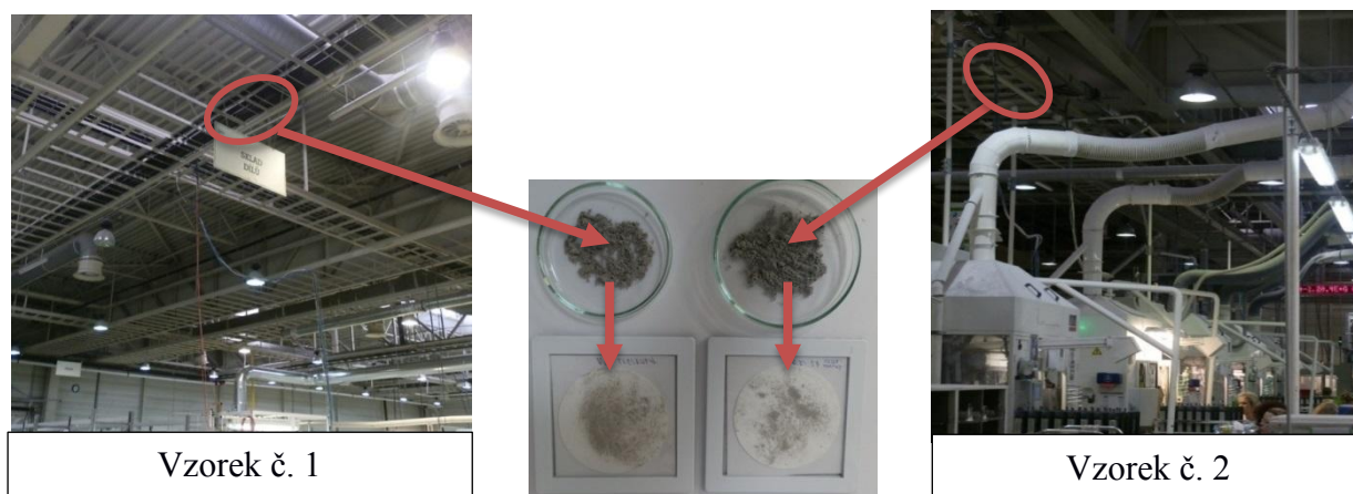
obr. 4-39: Analýza vzorků prachu z výrobní haly
