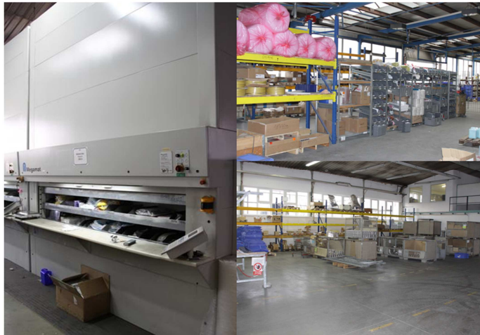
obr. 5-3 Systém Megamat a způsob skladování v hlavním skladu [12]
