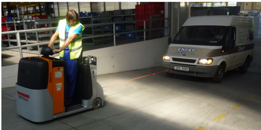
obr. 6-19 Zátěžový test modifikovaného tahače STILL CX-T [12]
