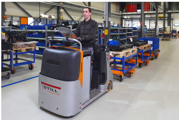
obr. 3-3 Interní Milk run zajišťovaný elektrickým tahačem [6]
