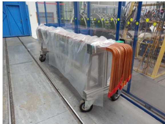
Obr. 6-2 Cívkové svazky vyrobené v Měďárně [vlastní zpracování]
