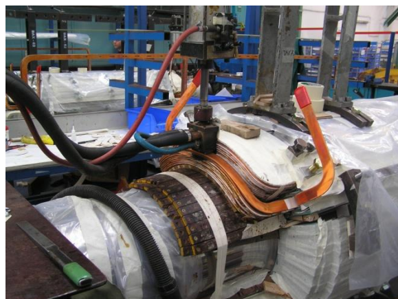
Obr. 6-4 Pájení dvojice cívek z cívkového svazku [vlastní zpracování]
