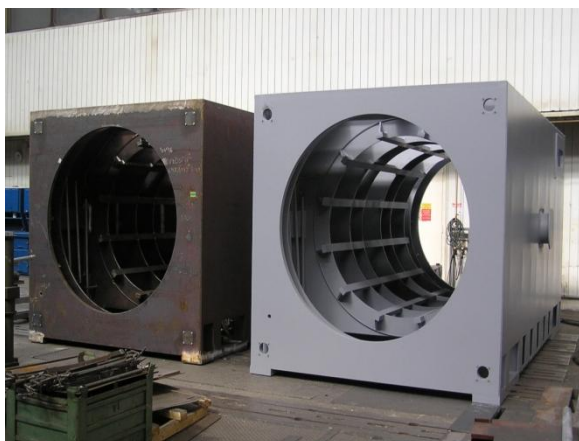
Obr. 5-2 Svařená a nabarvená kostra statoru [vlastní zpracování]
