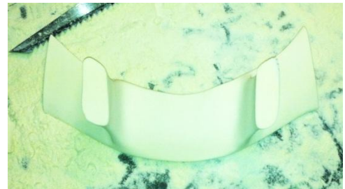
Přední část modelu s vyvrtanými bočními průduchy a přední přitlačné křídlo.
