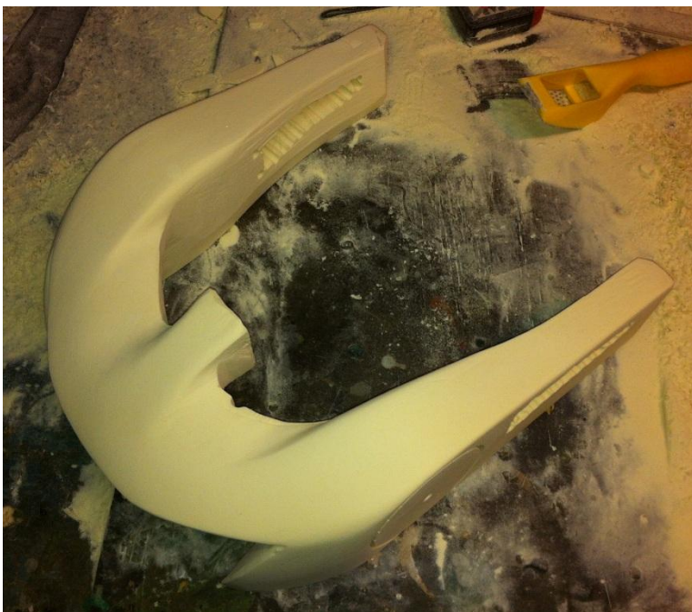
Přední část modelu s vyvrtanými bočními průduchy a přední přitlačné křídlo.
