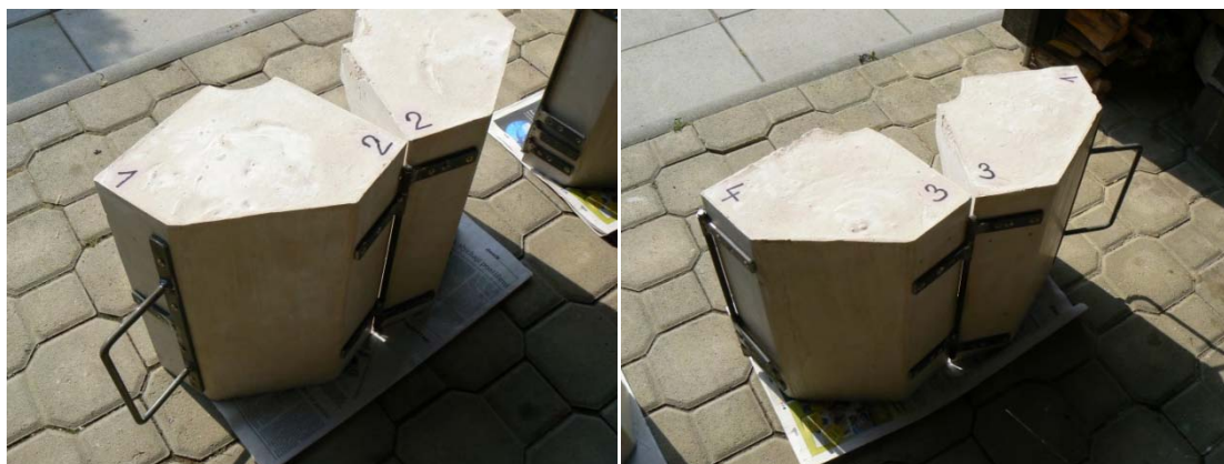
Obrázek 25 - kopyto se dvěma madly a třemi panty 25
