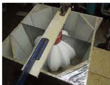
upevnění cylindru do formy
