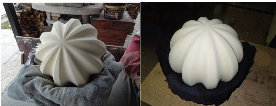
Obrázek 18 - finalizace polyuretanového modelu 18
