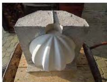
proces rozebírání formy - oddělení patizonu od kopyta
