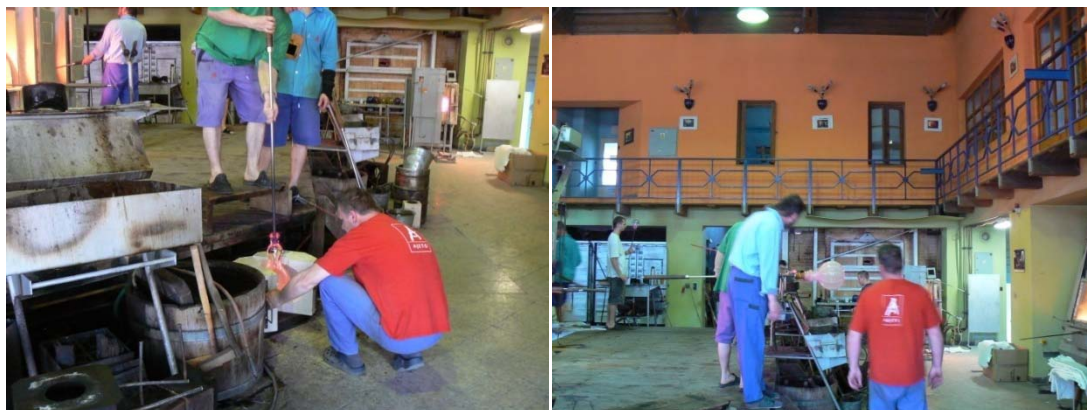
Obrázek 26 - foukání cylindru ve sklárně 29
