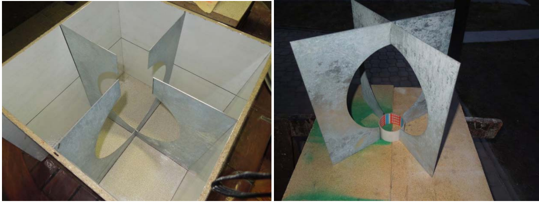
Obrázek 20 - forma s plechovými dělicími rovinami 20
