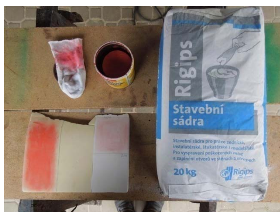
Obrázek 27 - zkouška adheze a koheze sádry vůči modelu 30
