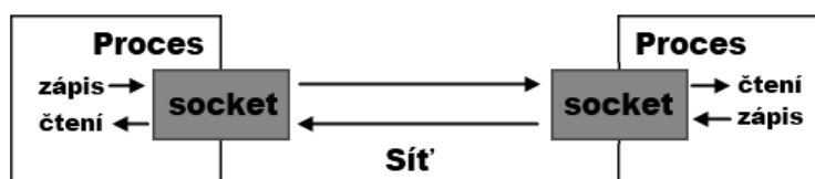
Obrázek 3: Schéma funkce soketu v modelu klient/server
