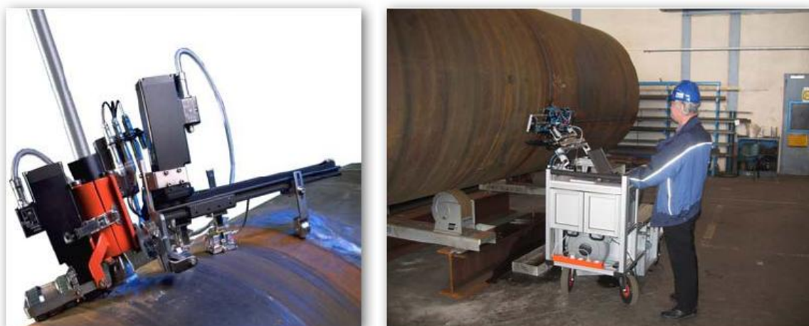
Obr. (7): Portálový robot s označením AWS-8 (vlevo) a robot určený pro potrubí s velkým průměrem s označením AMS-41 (vpravo). Oba stroje od firmy Force Technology. [13]
