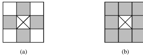
Obrázek č. 2.2: Okolí aktuálního bodu. (a) Čtyř-okolí aktuálního bodu. (b) Osmi-okolí aktuálního bodu. (aktuální bod označen křížkem)
