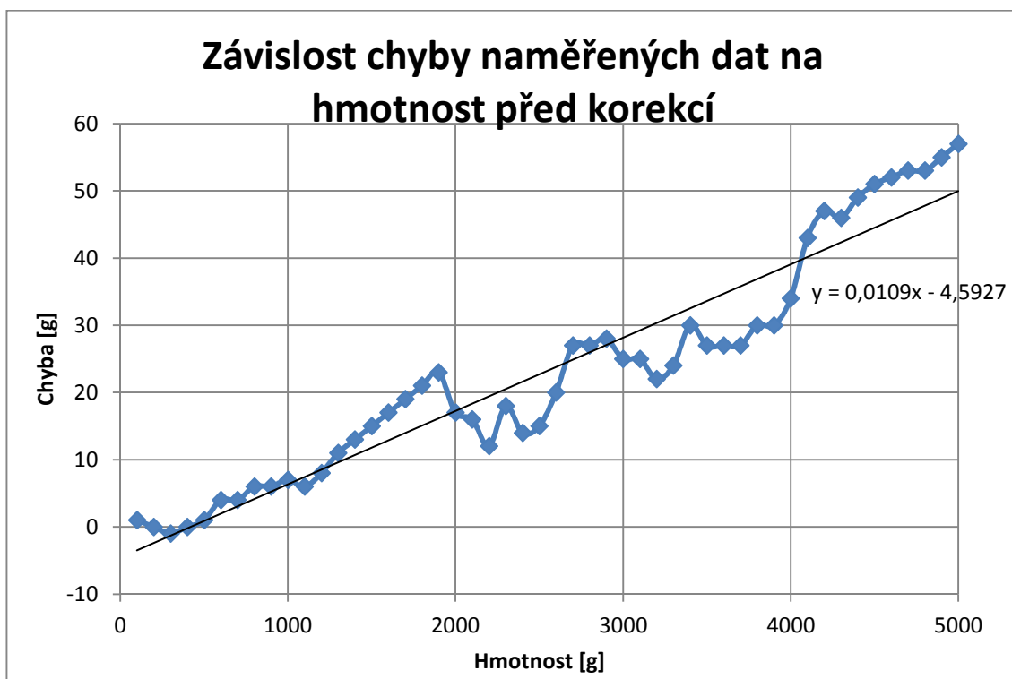
Obrázek 3.23 Graf závislosti chyby při použití 22bit převodníku před korekcí
