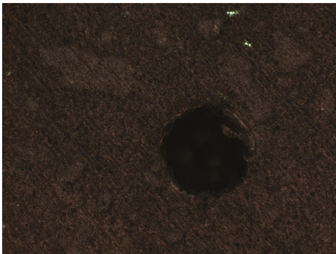
Obrázek 23. Zvětšený a prosvícený vzorek materiálu s 12 hm.% PANI plniva
