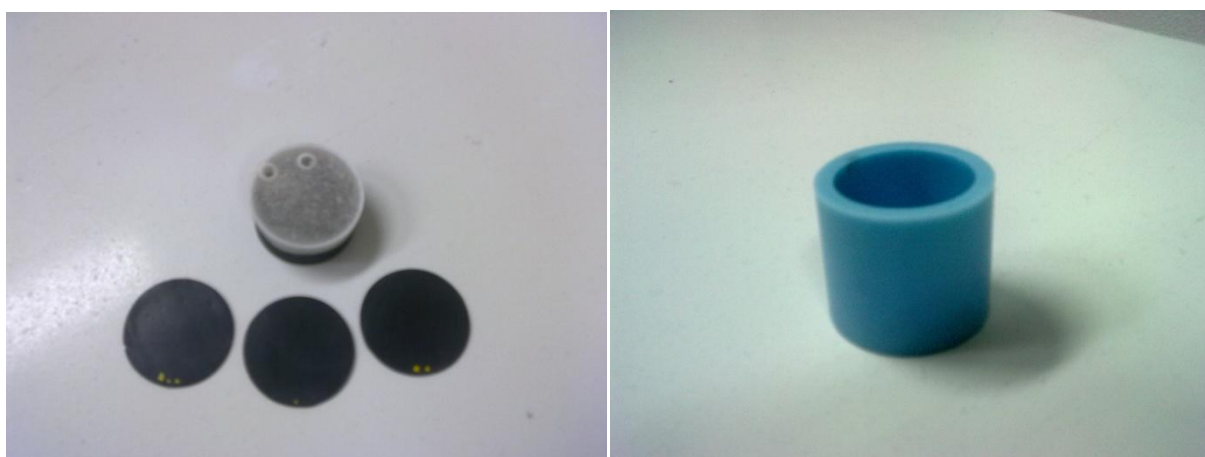
Obrázek 12. V levé části zobrazení 3 označených vzorků a materiál ve formě válce, ze kterého byly nařezány, a v pravé části je vyobrazena silikonová forma, která byla použita na odlití vzorků.
