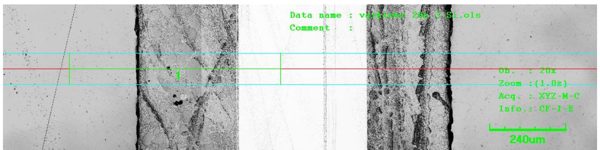
Obrázek 5.8 – Si čip zalitý v pryskyřici VariKleer
