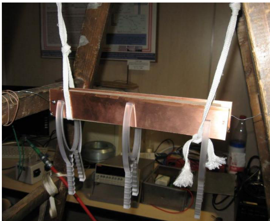
Obr. P2-3 Zavěšení zkušební vzorku při měření ztrátového činitele
