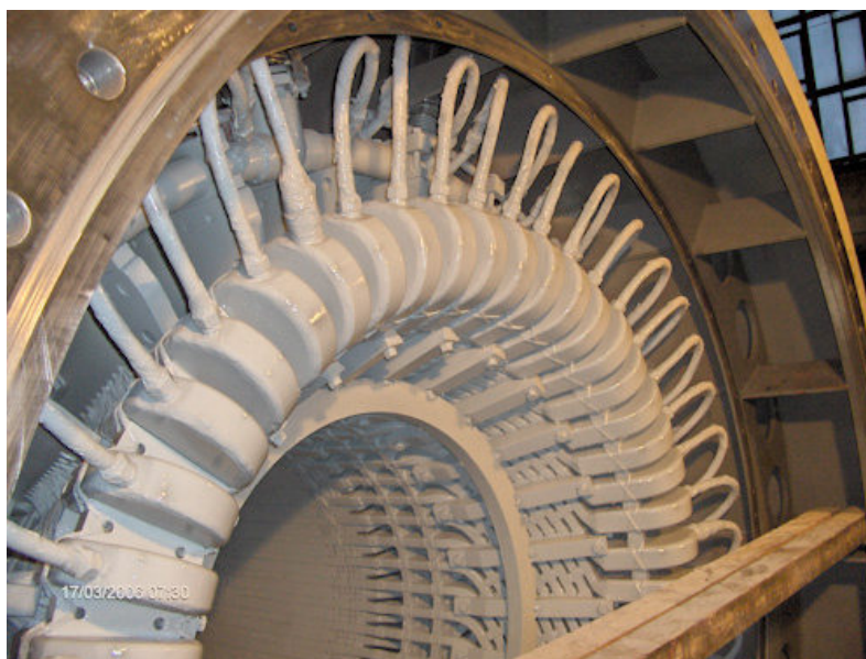
Obr. 2.6 Finální podoba čel vinutí (převzato z [8])
