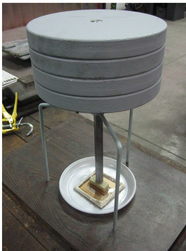
Obr. P3-4 Zkouška se zátěží 40 kg
