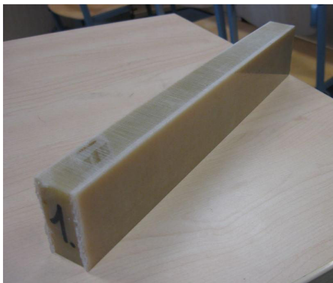
Obr. 3.4 Zkušební vzorek se zcela prosyceným finetem
