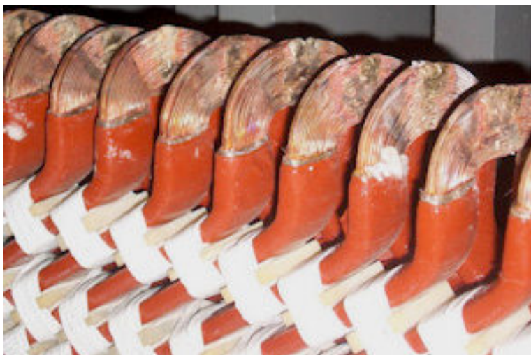
Obr. 2.5 Zapájená čela vinutí (převzato z [8])
