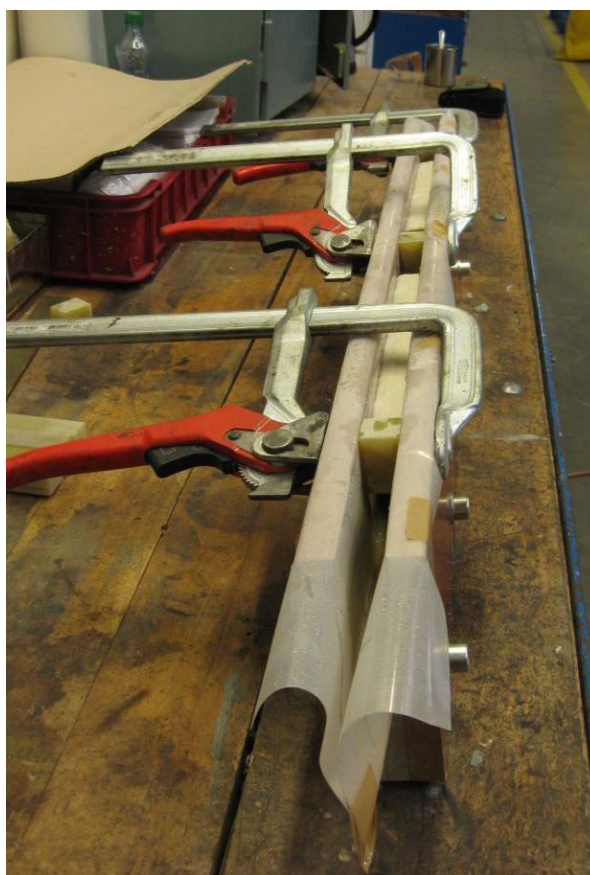
Obr. P2-2 Přípravek na výrobu zkušebních vzorků
