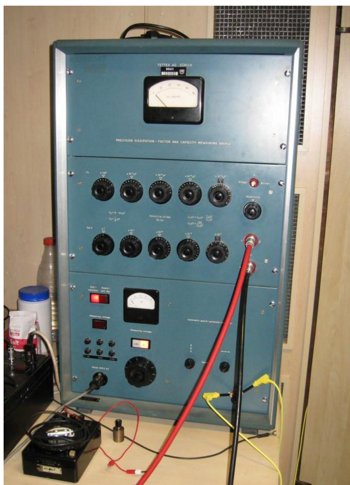
Obr. P2-4 Čtyřkapacitní Scheringův můstek pro měření ztrátového činitele
